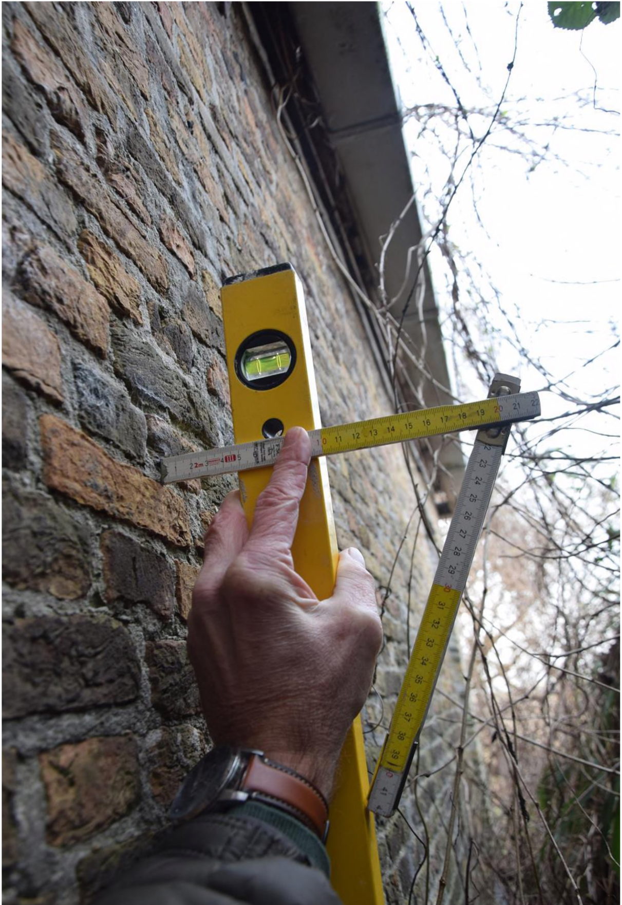
Scheefstand (achter)kopgevel 4,8mm/m 1
